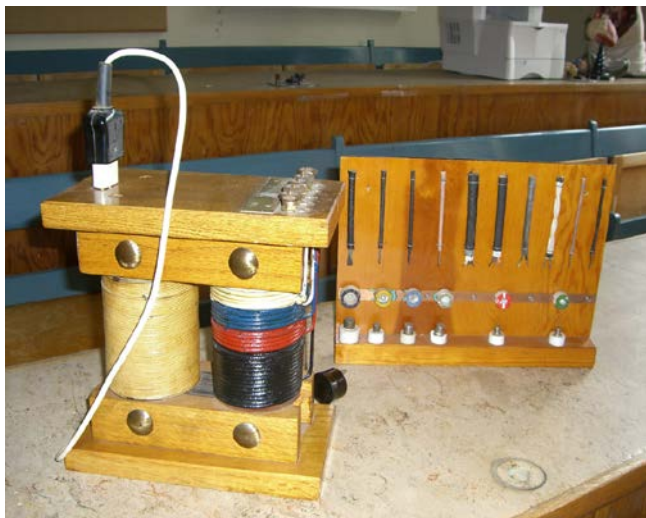
Barkveds solide transformator og ett av hans sikringsbrett. Til høyre en av Gjøsteens elektromotorer.
